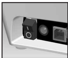
Alimentación eléctrica en OFF (Apagada)
